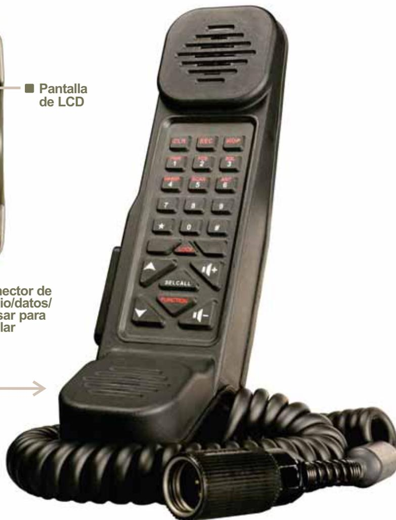
El sistema de radio táctico de VHF PRC-2080+ es un transceptor de comunicación portátil para uso militar diseñado específicamente para aplicaciones tácticas y para soportar inmersiones completas, vibraciones y caídas según las especificaciones de MIL-STD 810G.
