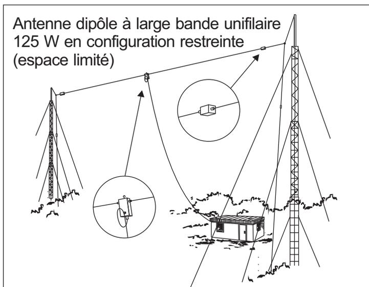
Antenne dipôle à large bande unifilaire
