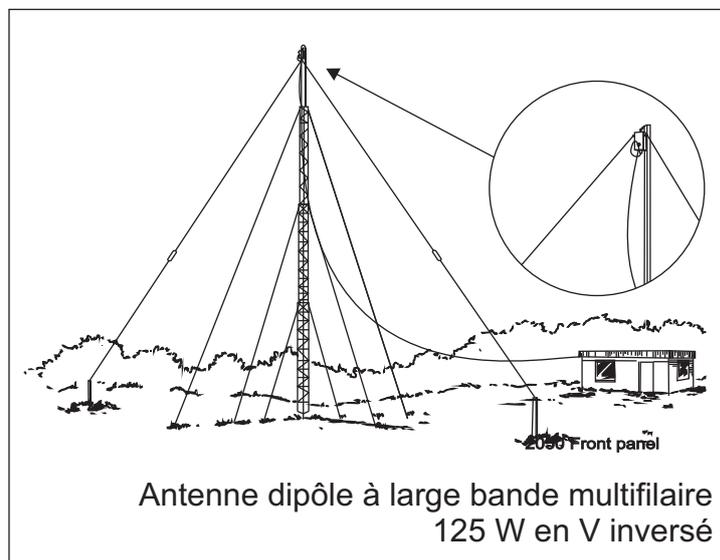
Antenne dipôle à large bande multifilaire
