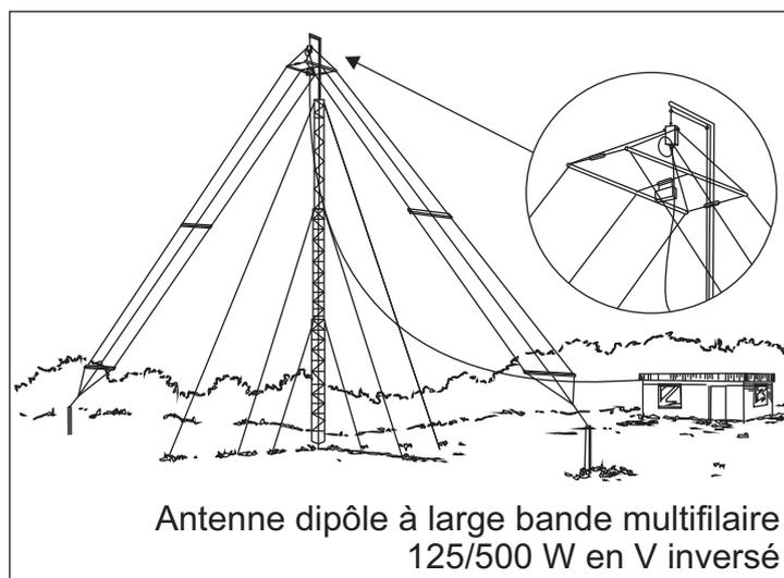
Antenne dipôle à large bande multifilaire
