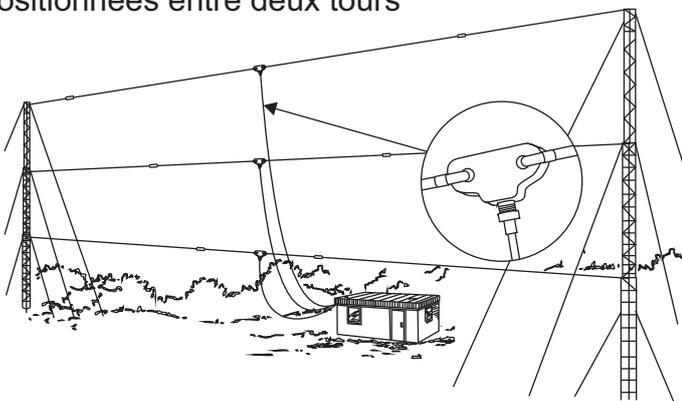
Antenne dipôle filaire mono fréquence en V inversé
