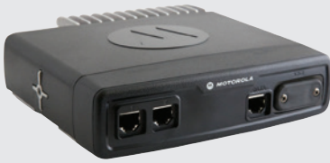
CABEZAL DE EXPANSIÓN ETHERNET 2 ESTÁNDAR, TIPO DE ETHERNET, LECTOR SIM ETHERNET Y RS232
