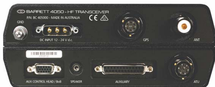
Задняя панель KB-трансивера Barrett 4050 SDR
