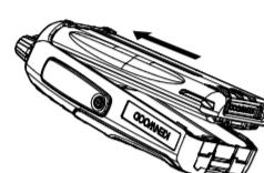
2 Zum Entfernen des Akkus ziehen Sie die Sicherungsreste an der Seite des Transceivers nach oben und drücken Sie auf die Entriegelungslasche unter der Sicherungsreste.
