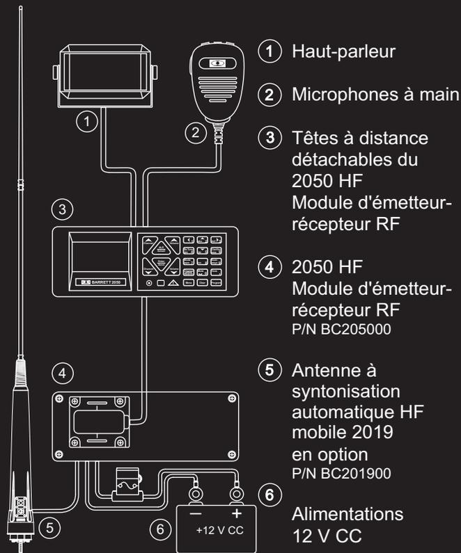
**Exemple de configuration de station de base d'émetteur-récepteur 2050 HF**
