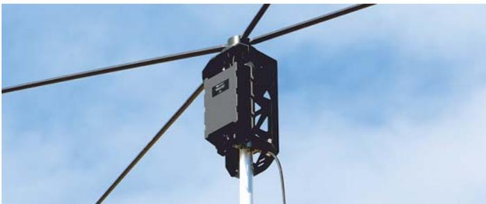
El sintonizador de antena Barrett 4011 se muestra como parte del sistema de antena dipolo horizontal de sintonía automática del Barrett 4017. Número de pieza BC401100 de Barrett Communications
