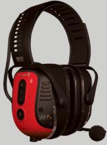
SM1PBEX02 | HEADBAND 27dB NRR / 33dB SNR / 31dB, Class 5 SLC80
