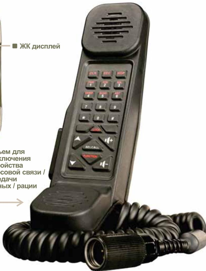
Тактическая УКВ радиостанция PRC-2080+ относится к классу портативных коммуникационных систем военного назначения, специально разработана для тактического применения. Радиостанция устойчива к полному погружению в воду, вибрации, падению в соответствии с MIL-STD 810G.
